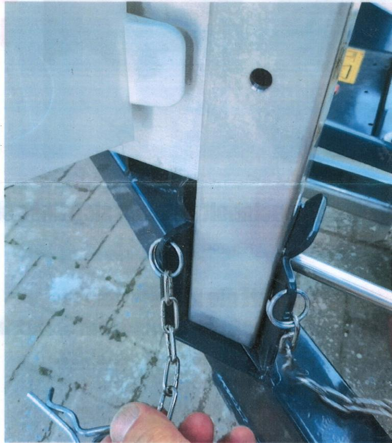
**Das komplette Stützrad mit Deichsel muss bei geringeren Höhen umgeklappt werden. Bei Höhen in ca. 8-18 Metern kann man dies so belassen**
